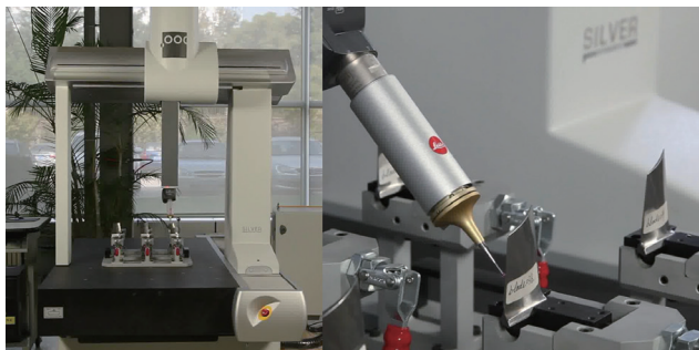
图1 GLOBAL Silver系列的三坐标测量机 Fig. 1 CMM of GLOBAL Silver series
